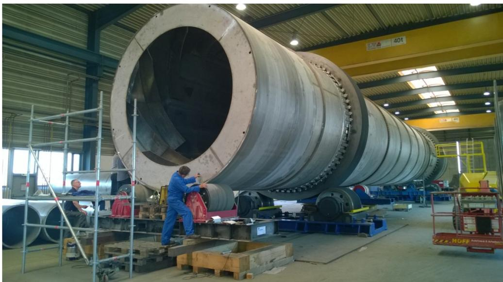
Рис 1: Большой вращающийся барабан из нержавеющей стали в производственном цехе (диаметр 4,5 метра, длина 35 метров) для сушки удобрений 320 т/ч
