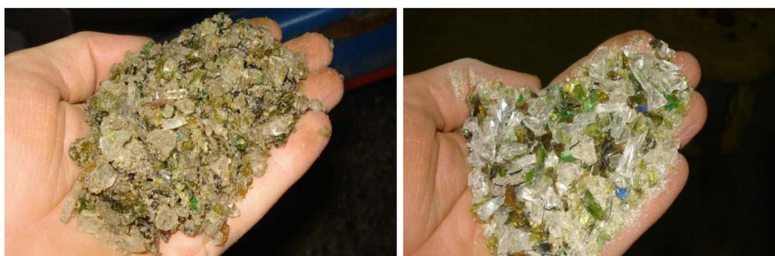
Рисунок 19: Вторичное стекло <10 мм до и после сушки
