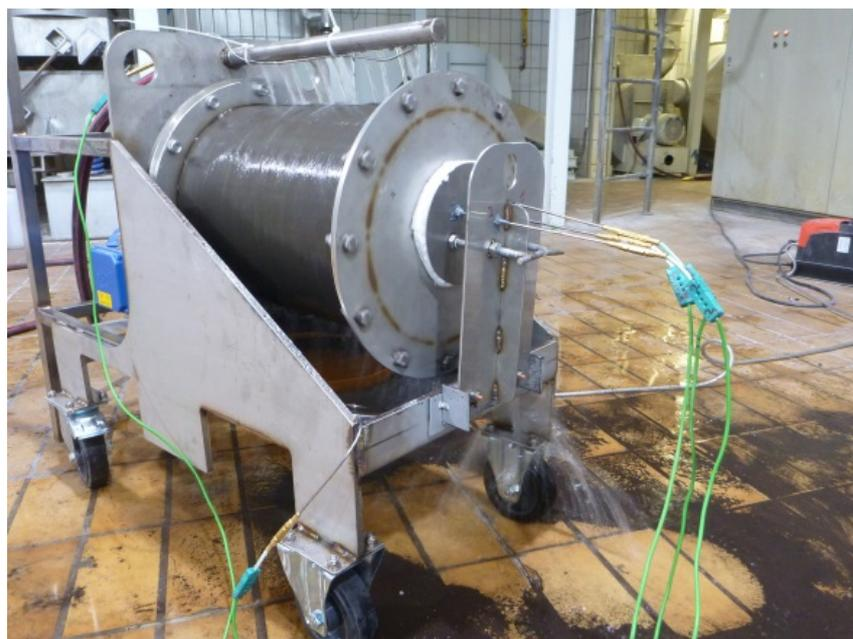
Рисунок 30: Лабораторный охладитель периодического действия для определения свойств сыпучих материалов и теплопередачи твердых веществ
