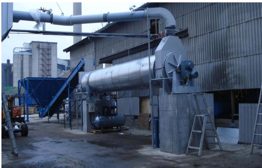
Рисунок 18: Барабанная сушилка для вторичного стекла
