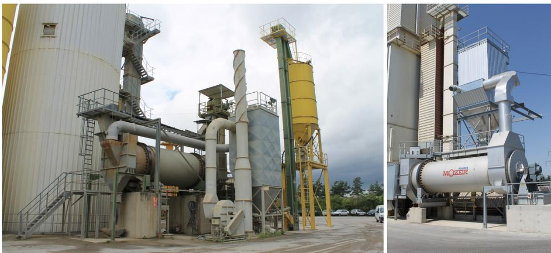
Рисунок 7: Ротационные барабаны для комбинированной сушки и охлаждения песка
