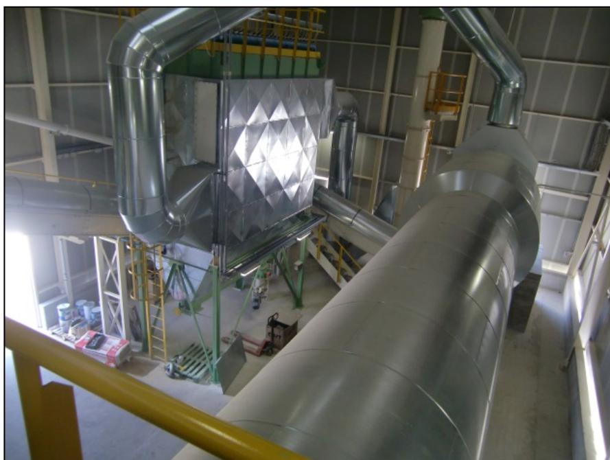
Рисунок 25: Система сушки TRH для очистки известняка
