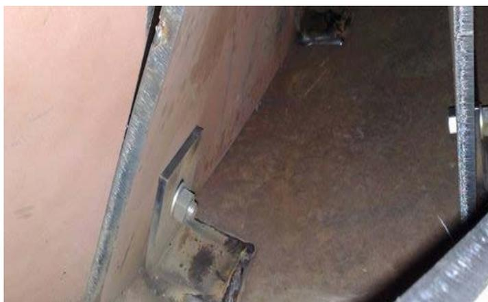
Рисунок 20. Прикрепленные болтами компоненты, установленные в барабанной сушилке
