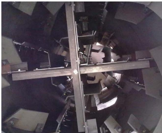
Рисунок 21: Крестовина установленных компонентов в барабанной сушилке
