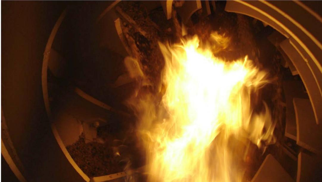
Рис. 2: Вид на сушильный барабан с пламенем внутри барабана
