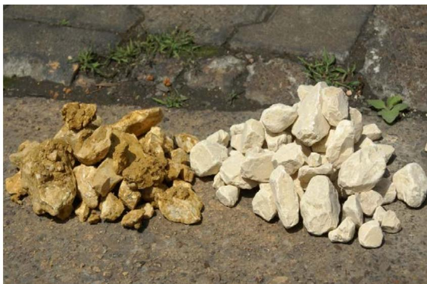
Рисунок 26: Образцы известнякового камня до и после сушилки TRH
