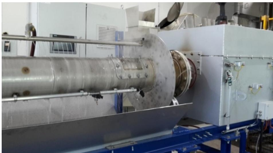
Рисунок 31: Испытательная установка для непрерывного охлаждения твердых частиц.
