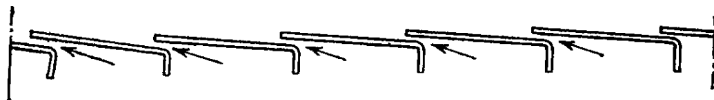
Рис. 35. Щелевая плоская газораспределительная решетка: а—желобчатая; б—плоская беспровальная.
